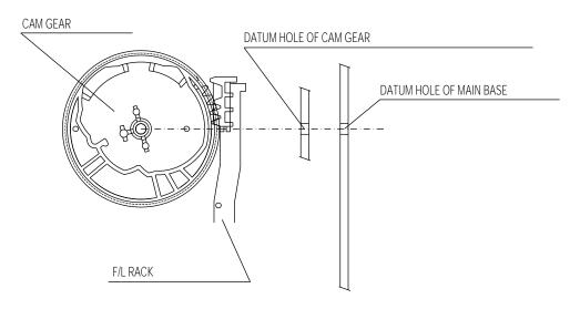
Fig.4-1 DATUM POSITION OF F/L RACK & CAM GEAR
